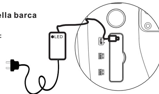
B) Carica la mini batteria del portatile
